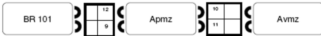
Abb. 11: Zuordnung der Puffer, Entgleisung 29.09.2012
